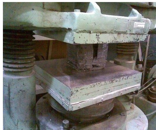
Рисунок 4 – Экспериментальное испытание бетонного образца-куба, армированного двумя слоями углеродных фиброволокон MBT-MBrase
