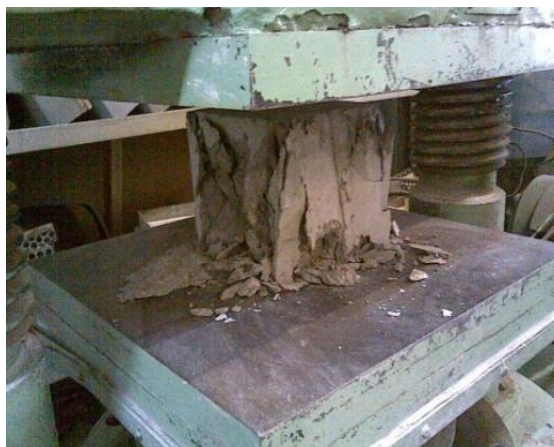
Рисунок 3 – Экспериментальное испытание бетонного образца-куба, не имеющего армирование углеродными фиброволокнами MBT-MBrase
