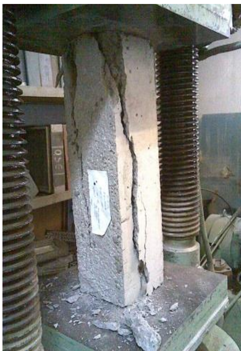
Рисунок 5 – Экспериментальное испытание неармированного углеродными фиброволокнами MBT-MBrase бетонного призмического образца
