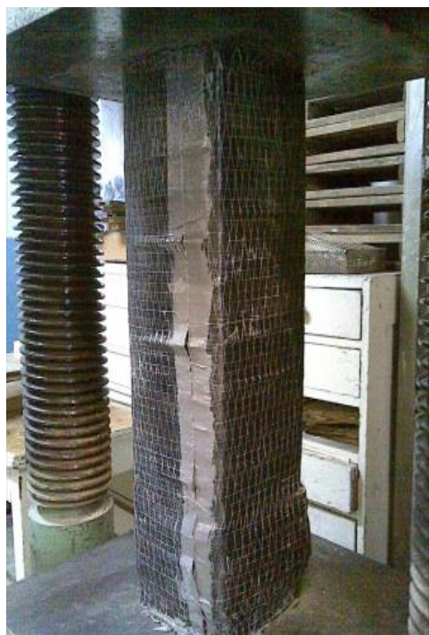
Рисунок 6 – Экспериментальное испытание бетонного призмического образца, армированного углеродным фиброволокном MBT-MBrase
