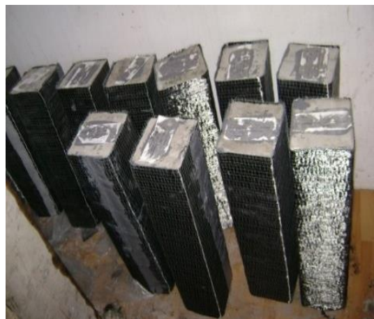
Рисунок 2 – Бетонные образцы-призмы, армированные углеродными фиброволокнами MBT-MBrase
