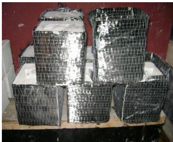
Рисунок 1 – Бетонные образцы-кубы, армированные углеродными фиброволокнами MBT-MBrase
